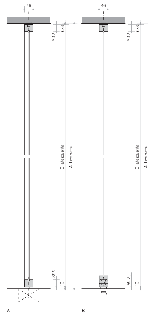
A. sez. verticale con chiudiporta a pavimento B. sez. verticale con chiudiporta incassato nel doppio traverso C. dettaglio cerniera a forbice a soffitto con rinforzo D. dettaglio chiudiporta a pavimento E. dettaglio chiudiporta incassato nel doppio traverso A. Vertical section with door closer on the floor B. Vertical section with door closer built in the double profile C. Detail of "scissor" hinge in the ceiling, with reinforcement D. Detail of door closer on the floor. E. Detail of door closer built in the double profile
