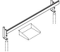
Barra singola con supporti per basi / Single bar with brackets for bases / Einzelstange mit Stützen für Basisplatten / Barre simple avec supports pour piétement / Barra individual con soportes para bases
